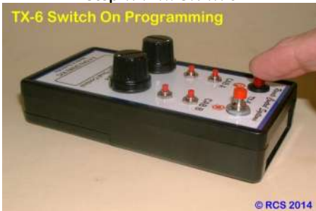
Step 2. Press & HOLD F2 & F4 buttons.
